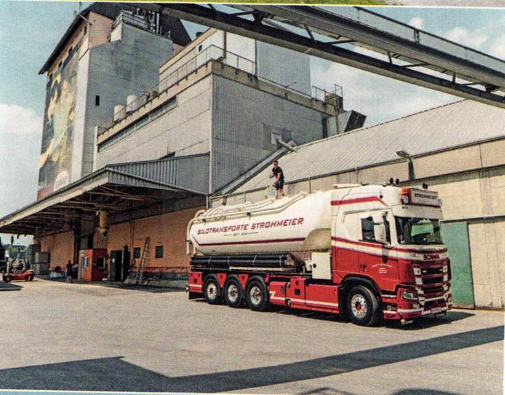
die speziell für den Transport von Pellets für industrielle Abnehmer und private Haushalte zum Einsatz kommen, sind mit einem On-Board-Wiegesystem ausgestattet, damit garantiert wird, dass unsere Kunden mit genau jener Menge Holzpellets beliefert werden, die sie benötigen. Damit wir im Geschäftsfeld Holzpellets noch besser aufgestellt sind, haben wir für Anfang sowie für Ende 2023 je ein weiteres Fahrzeug mit Wiegesystem geordert.
